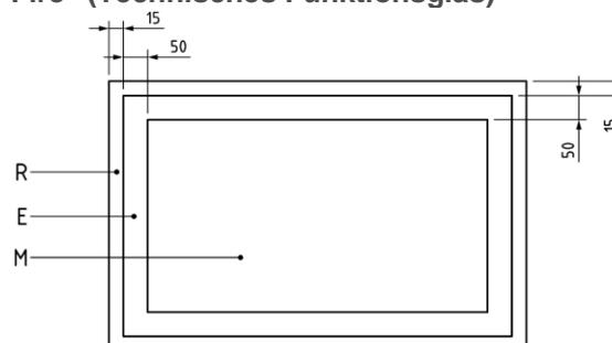
R = Zone von 15 mm, die üblicherweise vom Rahmen abgedeckt ist oder bei einem rahmenlosen Rand dem Randverbund entspricht (Falzzone)
